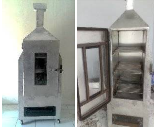
Gambar 2. Alat pengasapan ikan : a) Tampak depan, memperlihatkan keseluruhan alat; dan b) Tampak bagian dalam, memperlihatkan rak-rak pengasapan
