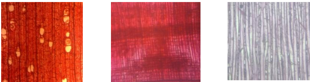
Gambar 3. Pengamatan mikroskopis penampang melintang 25x (a), radial 50 x (b) dan tangensial 100 x (c)
