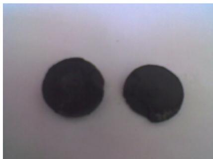
Gambar 1. Material LSM hasil sintering pada suhu 1350°C
